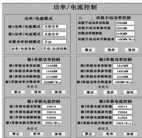
图 2 单极功率自动控制功能实现原理
