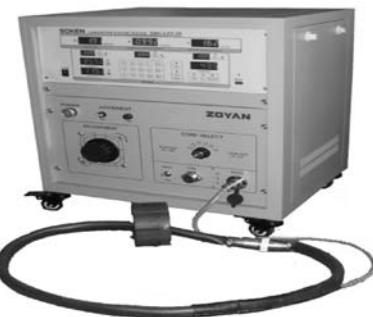
图 1 电动机铁心磁性测试专用装置
