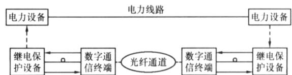
图1 光纤差动电流保护系统结构
